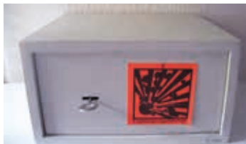
Abb. 4: Stahlbehälter zum Aufbewahren von Böttlerpulver
